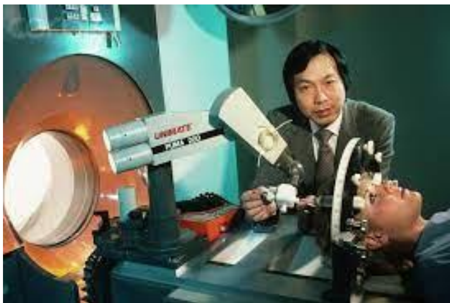
Hình 26. Robot PUMA 1985 – PUMA 200-1990 hỗ trợ sinh thiết U não, thay chỏm xương đùi
